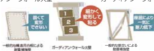
一般的な構造用石膏による耐震補強壁 ガーディアンウォール壁 一般的な筋交いによる耐震補強壁
