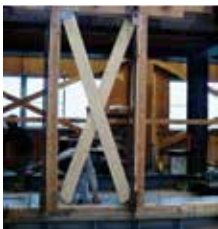
耐力壁加力試験風景
