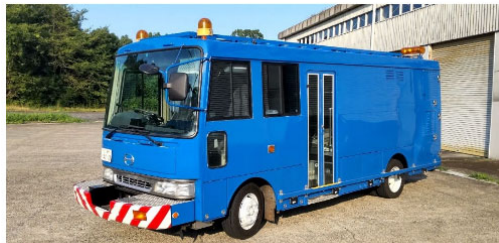
出典：移動式たわみ測定装置(MWD)（国立研究開発法人土木研究所）
