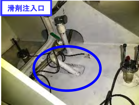
滑剤充填設備(中央JCT Bランプシールドトンネル工事の実績)
