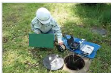
地下水位の観測状況
