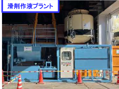
滑剤充填設備(中央JCT Bランプシールドトンネル工事の実績)
