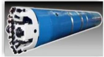
シールドマシン等による管渠の新設により、ポンプ圧送方式から自然流下方式へ切り替えることでポンプ場を廃止します。
