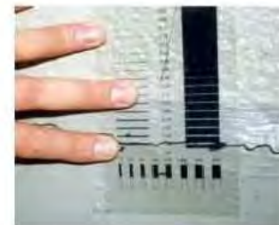
例: 亀裂損傷調査
