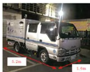
路面下空洞探査車
