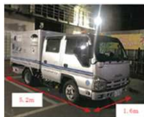
路面下空洞探査車
