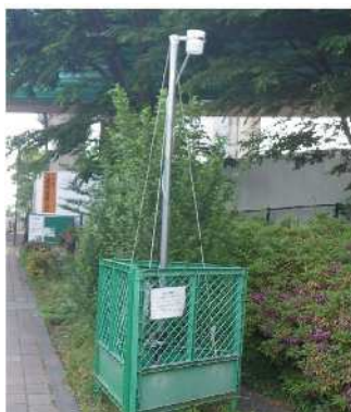
大気質 (粉じん等) 測定状況
