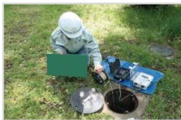
地下水位の観測状況
