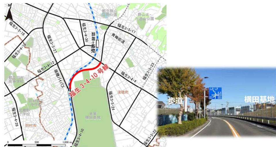
福生3・4・10号線 計画幅員18m 現道幅員約12.5m
