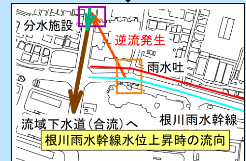
流域下水道への 逆流イメージ
