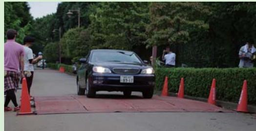
車両がハンプを通行する時の騒音・振動や車内での揺れを比較、体験しました。また、低床型バスの車体底部と路面との間隔を測定しました。
