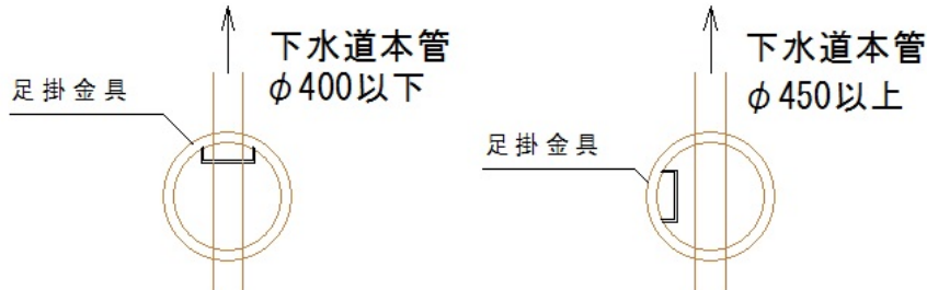
図2-4 人孔の足掛け金具設置 平面図
