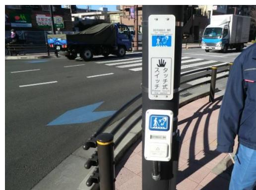
図 2.15 音響式信号機(右はタッチ式のボタン)
