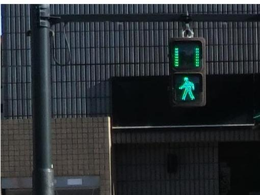
図 2.16 経過時間表示式信号機
