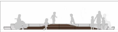
ベンチ④ ：スロープ・段状ベンチ 子どもが高低差やスロープを楽しみ、親子で休憩することができる。多人数が滞在可能な複合型の休憩施設。車いす利用者にも配慮する。
