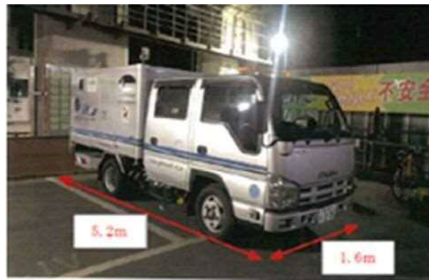
路面下空洞探査車(車載型レーダー)
