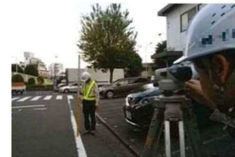
水準測量作業(イメージ)
