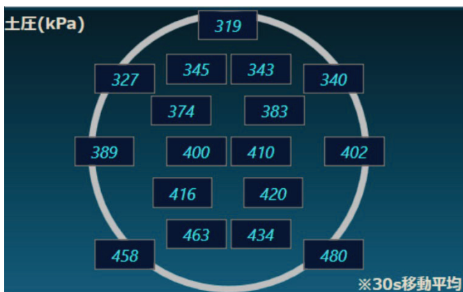
チャンバー内圧力勾配のリアルタイム監視状況
