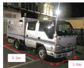
路面下空洞探査車
