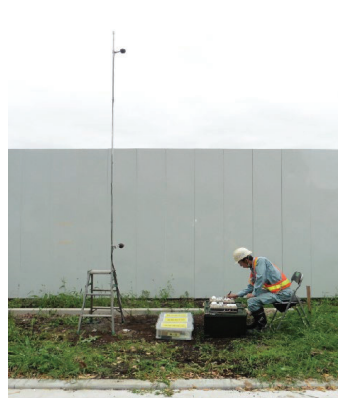
騒音、振動測定状況
