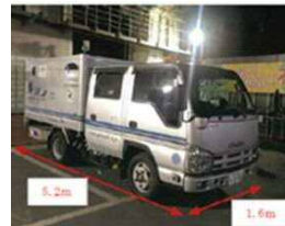
路面下空洞探査車
