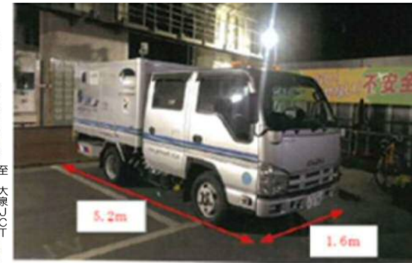
路面下空洞探査車(車載型レーダー)
