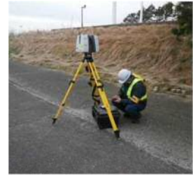
3D点群データ計測調査 地上計測
