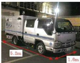
路面下空洞探査 （車載型レーダー）
