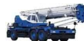
25～50tラフタークレーン
