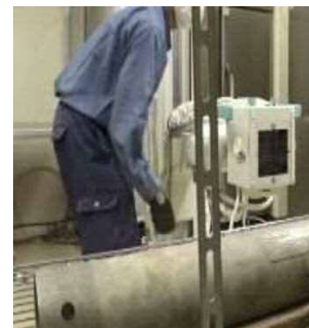
<不攪乱試料のX線検査>
