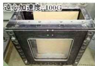
遠心模型実験用土槽
