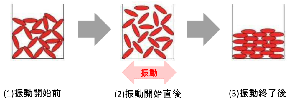
図 振動中の粒子の挙動
