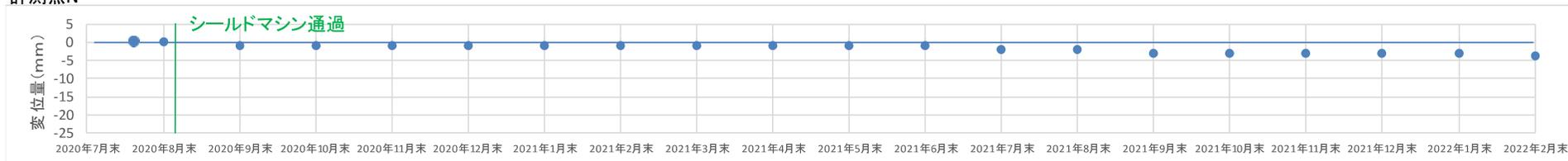
計測点O ※地表面の沈下が継続している傾向が確認されたことから、シールドマシン通過後に追加した計測点
