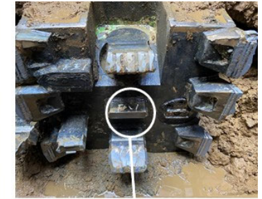
ビットの損傷状況
