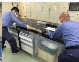
(押し棒を利用した人力による取り出し) ※鉛直向きに押し出すと試料が折れる可能性があるため
