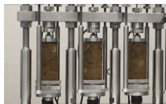
試験状況(一軸圧縮試験)
