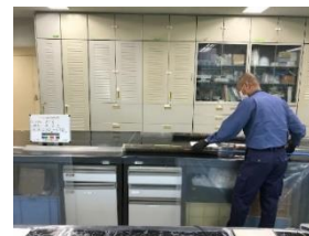
(押し棒を利用した人力による取り出し) ※鉛直向きに押し出すと試料が折れる可能性があるため
