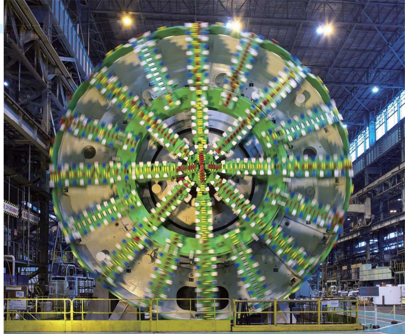
シールドマシンのカッターヘッドの回転状況
