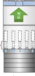
シールドジャッキ伸長大
