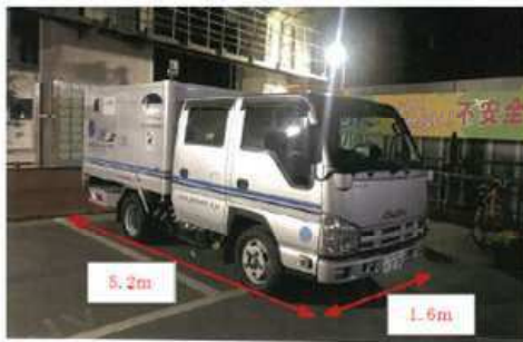
路面下空洞探査車（車載型レーダ）
