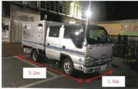
路面下空洞探査車（車載型レーダ）
