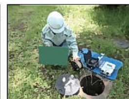
地下水位の観測状況
