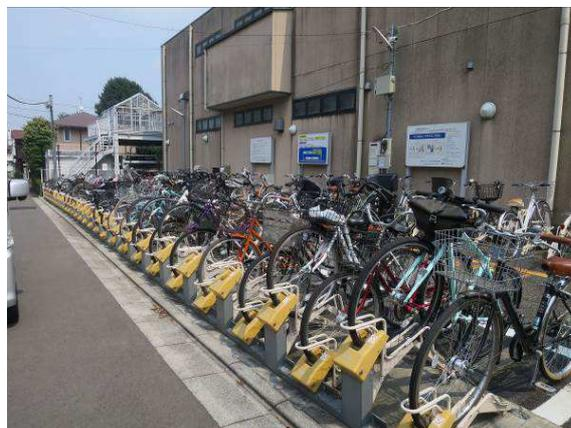
図 18 ロック式システムの例
