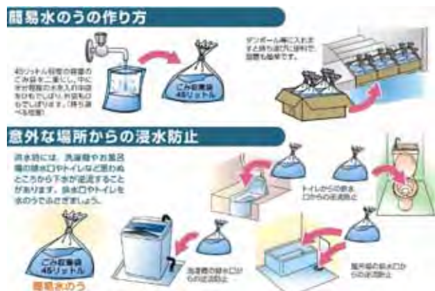
図 4-21 簡易水のうの作り方
