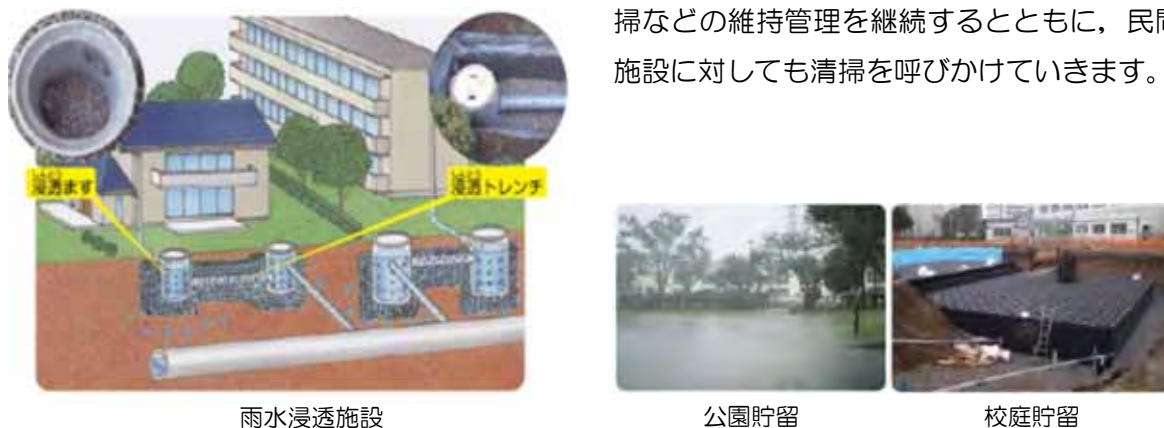
図 4-4 雨水浸透施設，雨水貯留施設の例
