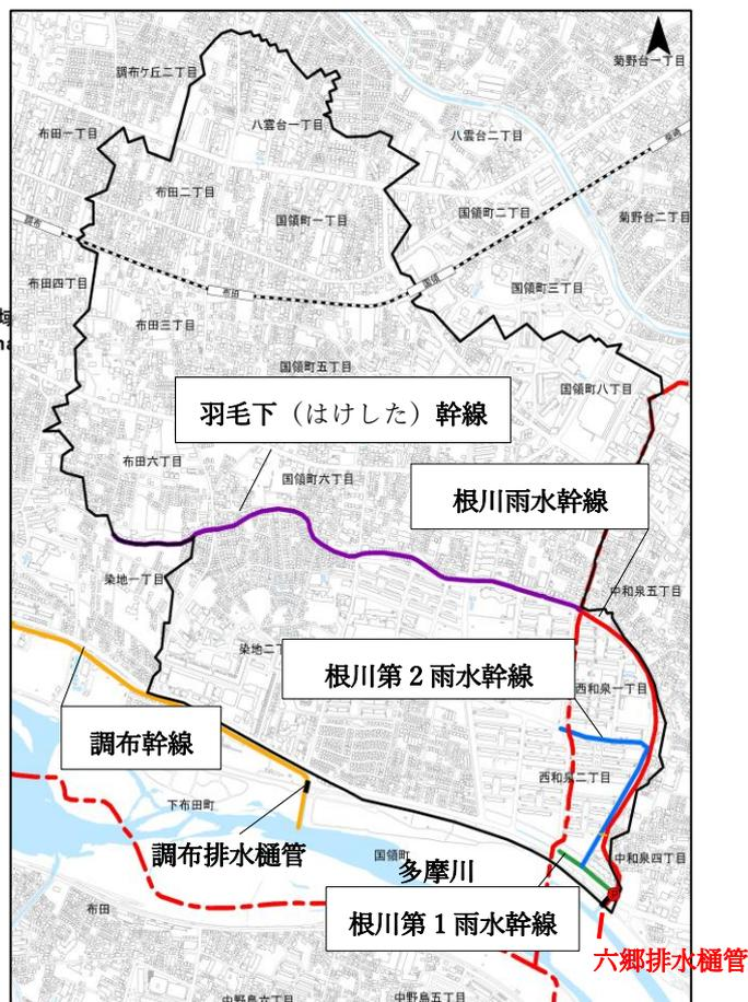
図 2-2-2 羽毛下・根川雨水幹線流域図
