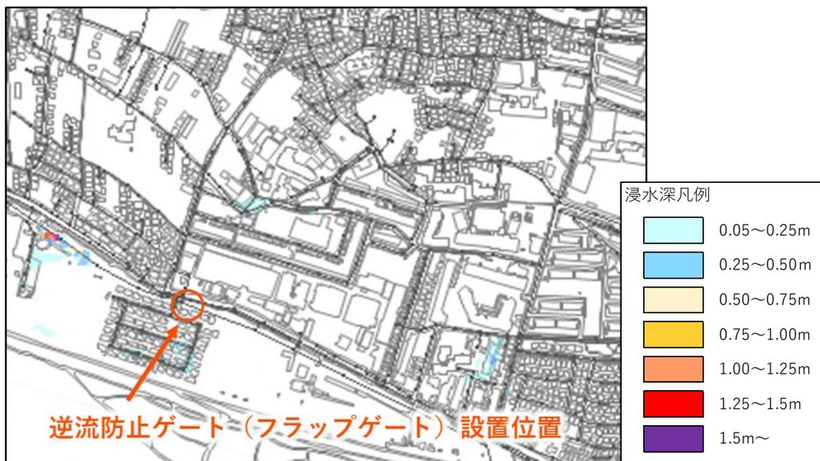
図 3-2-3 逆流防止ゲート設置後浸水状況（樋管操作+多摩川の河道掘削+逆流防止ゲート設置）
