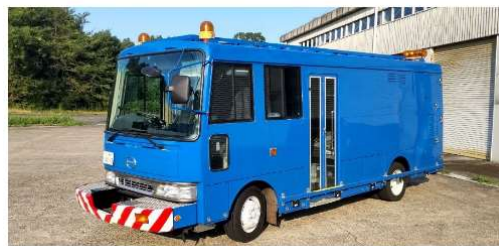
図 4-16 移動式たわみ測定装置(MWD)積載車両の例
